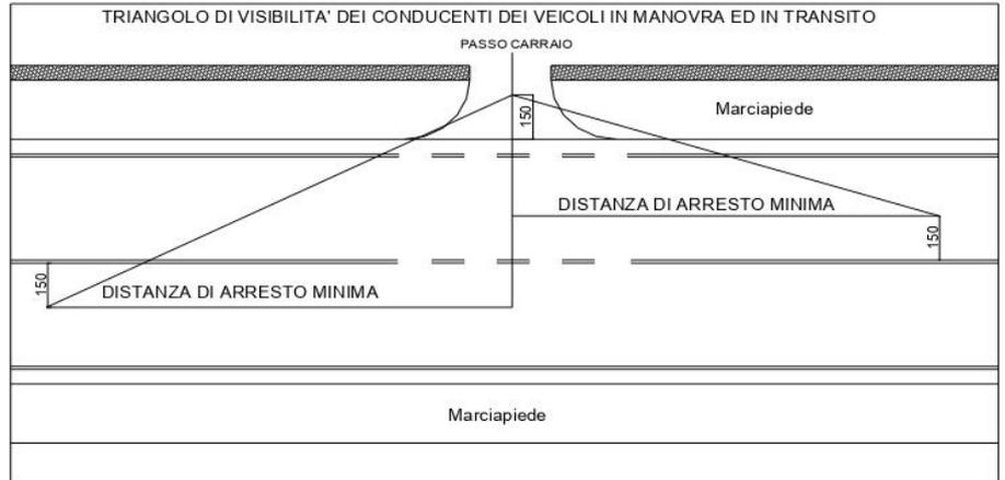
L'area di reciproca visibilità, sgombra da qualunque impedimento visivo, sarà individuato da un triangolo avente, in corrispondenza dell'asse del varco di accesso, un cateto maggiore pari alla distanza di avvistamento ed arresto relativa alla velocità consentita sulla strada principale, parallelo di 1.50 m all'asse stradale ed un cateto minore con il vertice distante 1.50 m dal ciglio stradale (marciapiede o muro di recinzione)
