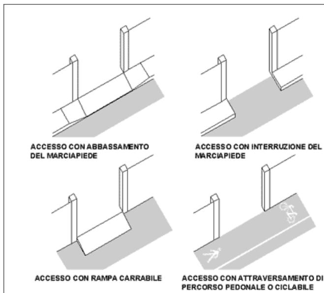
**Passi carrai attraverso marciapiedi** realizzati -con *scivoli carrabili*, per mantenere il percorso pedonale alla quota del marciapiede, -con *abbassamenti del marciapiede* e scivoli pedonali, -con *interruzione del marciapiede*, nel caso di marciapiede meno larghi di 60 cm,
