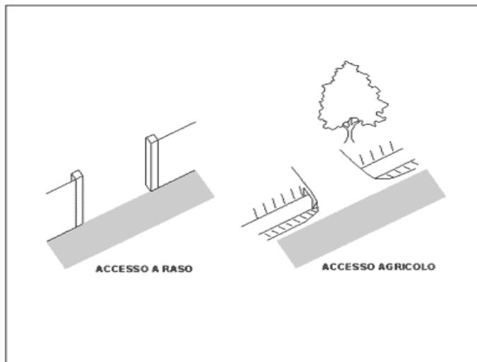
**Passi carrabili a raso**, con accesso alla quota del manto stradale, direttamente sulla banchina stradale.
