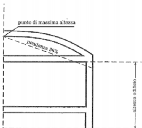
Fig. 9 - Edificio con copertura ad andamento variabile con proiezione della pendenza inferiore all'intradosso del solaio dell'ultimo piano abitabile
