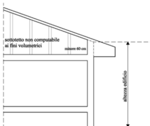
Fig. 15 - Edificio con dislivello inferiore a 60 cm e sottotetto intercluso a muricci e tavelloni
