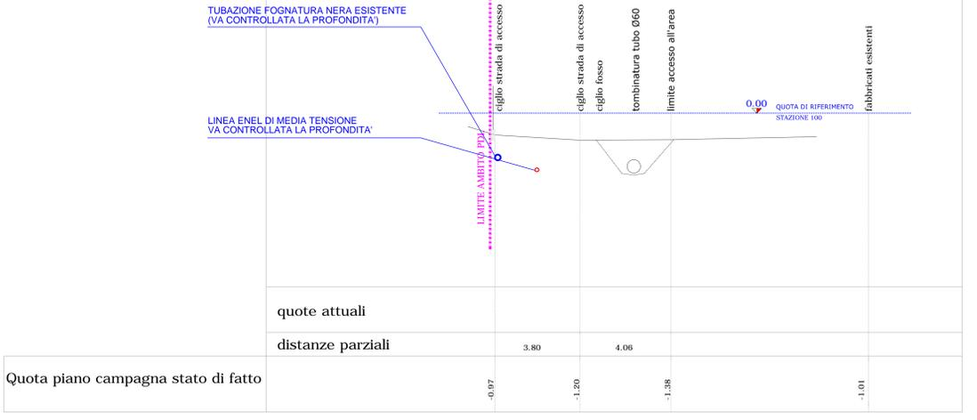
**SEZIONE S2 - STATO DI PROGETTO**
