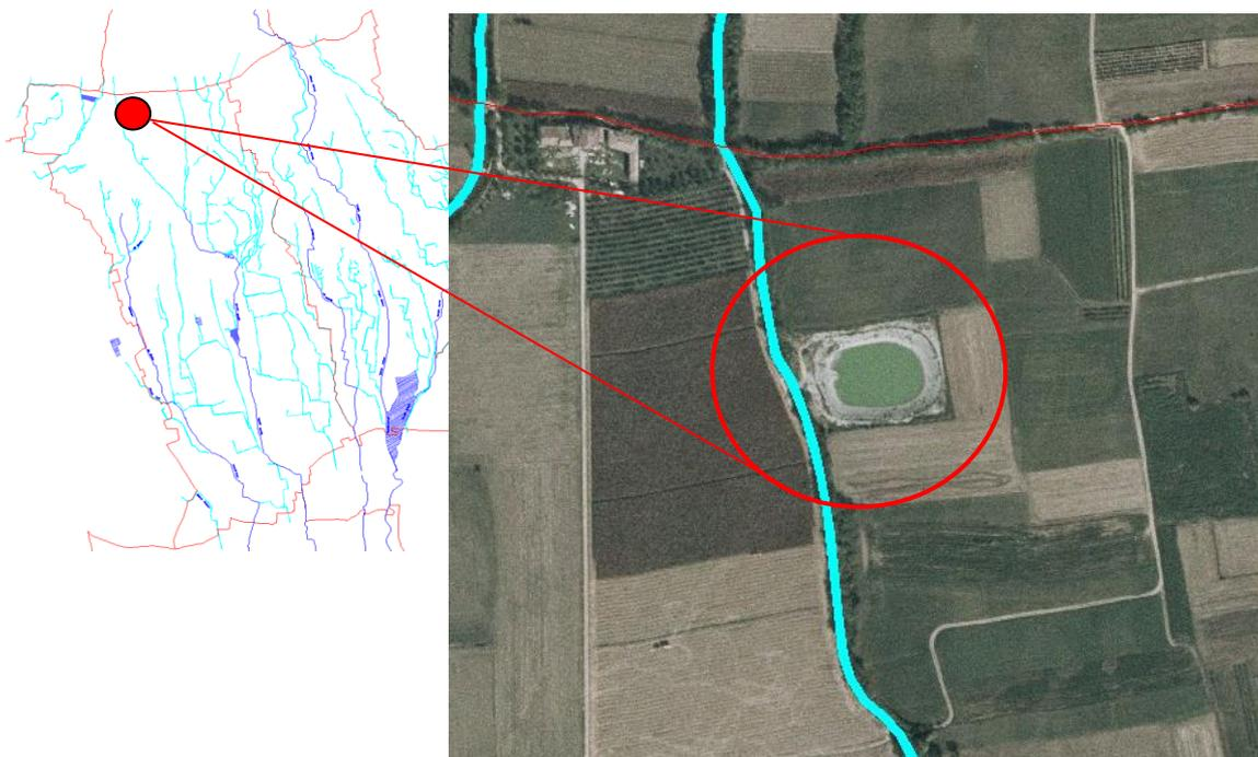
**Figura 9:** serbatoio per l'irrigazione potenzialmente utilizzabile quale cassa di espansione.
