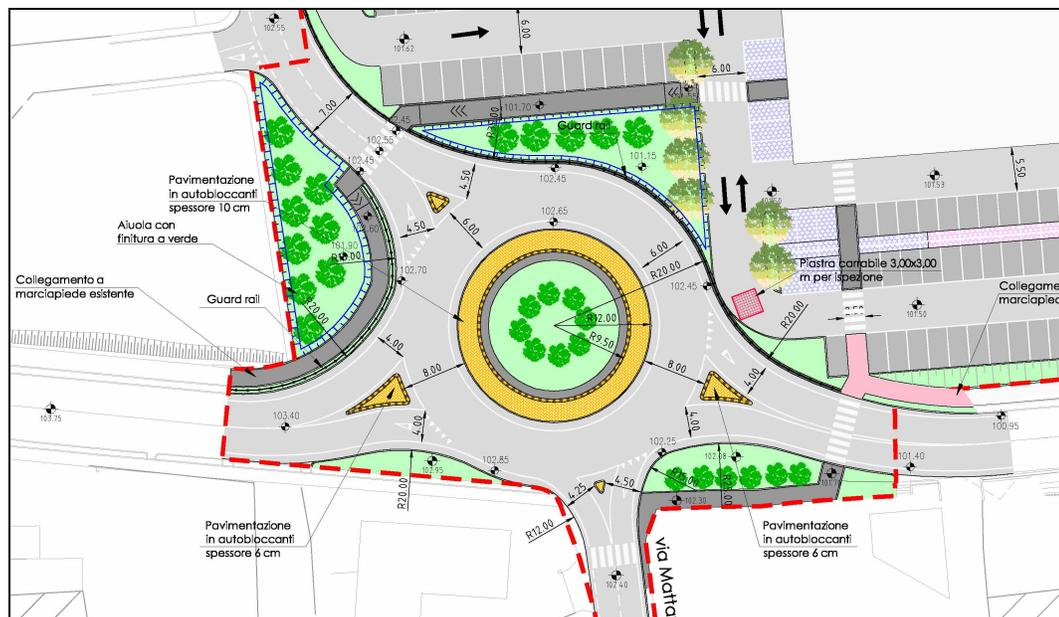
Fig. 3 – Planimetria di progetto.
