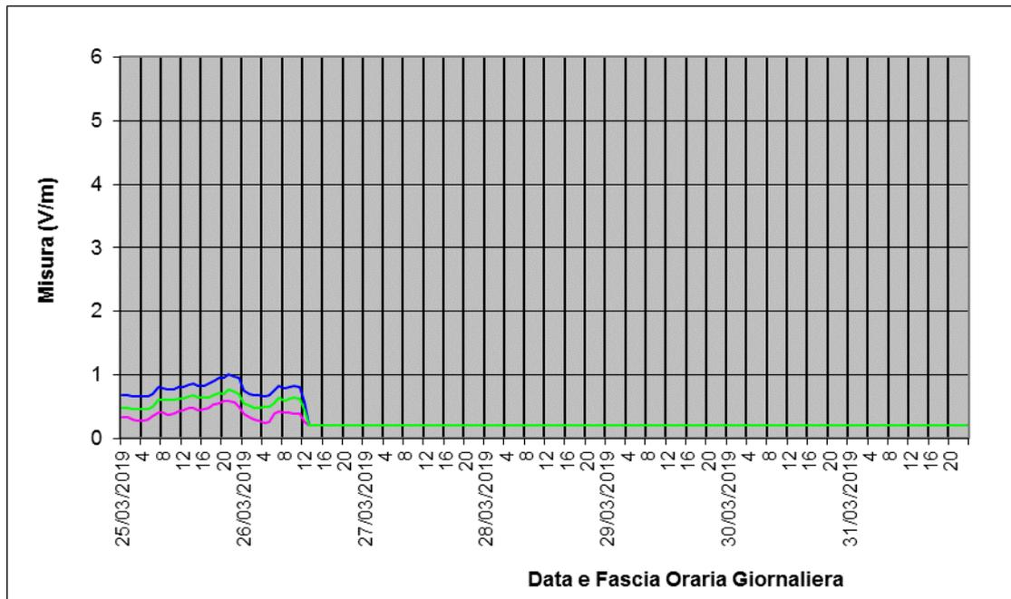
Nel diagramma non verranno mai visualizzati valori al di sotto della sensibilità dello strumento pari a 0,2V/m
