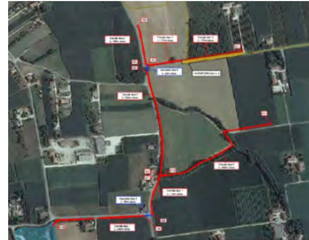
Si tratta del progetto di realizzazione di una cassa di espansione nella ex cava di via Praduani (ex cava Trentin) e della progettazione della relativa rete di collettamento delle acque, a protezione del centro abitato di Falzè di Piave. Per questo importante intervento, mirato ad eliminare i fenome-
