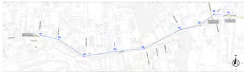
Procedono i lavori per il collegamento della rete fognaria di Sernaglia della Battaglia e Moriago al depuratore di Falzè di Piave. Si tratta di 800 metri di tracciato che viene posato con la tecnica del microtunneling, ossia una metodologia operativa che permette la posa di tubazioni senza ricorrere agli scavi a cielo aperto. **L'Amministrazione Comunale ha puntato al microtunneling proprio per evitare**
