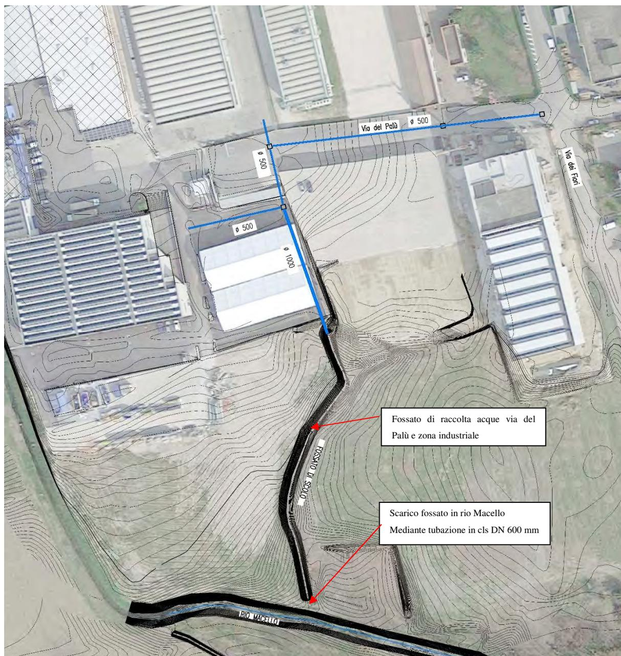
**Figura 52: Rete di drenaggio attuale dell'area di via del Palù e di parte dell'area industriale limitrofa a via dei Fiori e all'attuale alveo dello scolo Rio Macello. In azzurro sono indicate le tubazioni esistenti.**
