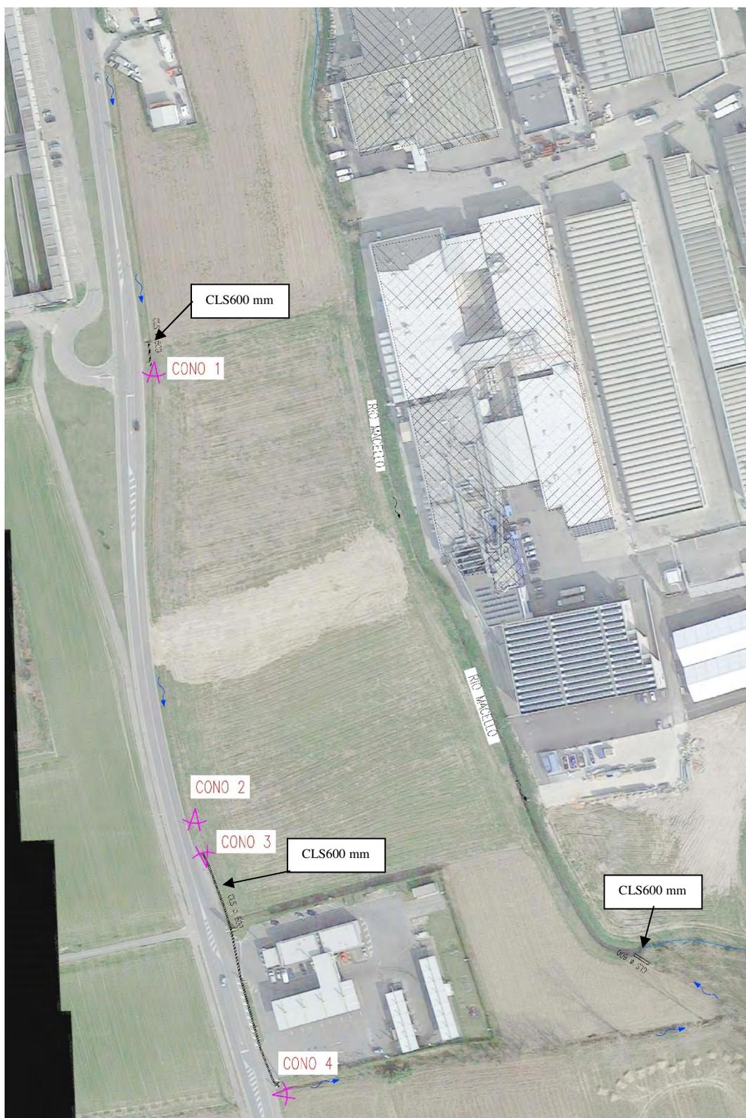
Figura 47: Coni visuali del fossato di scolo esistente lungo via dei Roveri ed indicazione dei tombinamenti esistenti.
