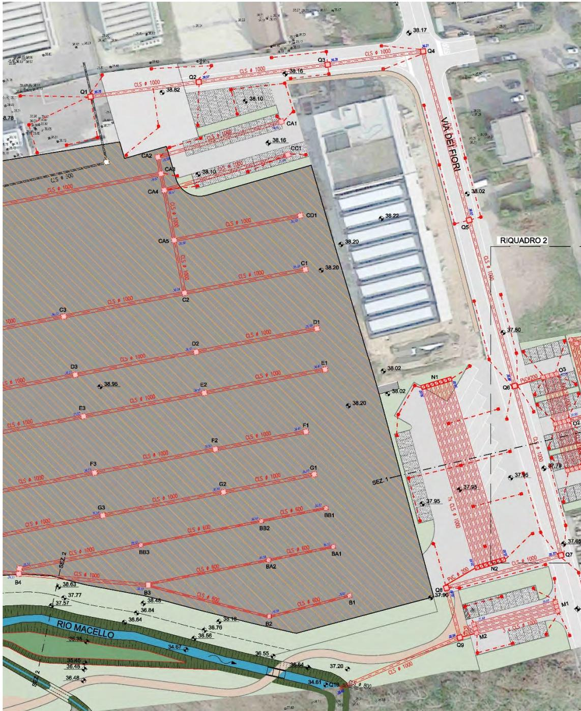
Figura 54: Estratto della planimetria di progetto, nuovo collettore DN 1000 mm di via dei Fiori e sistema di raccolta e collegamento secondario al collettore principale.
