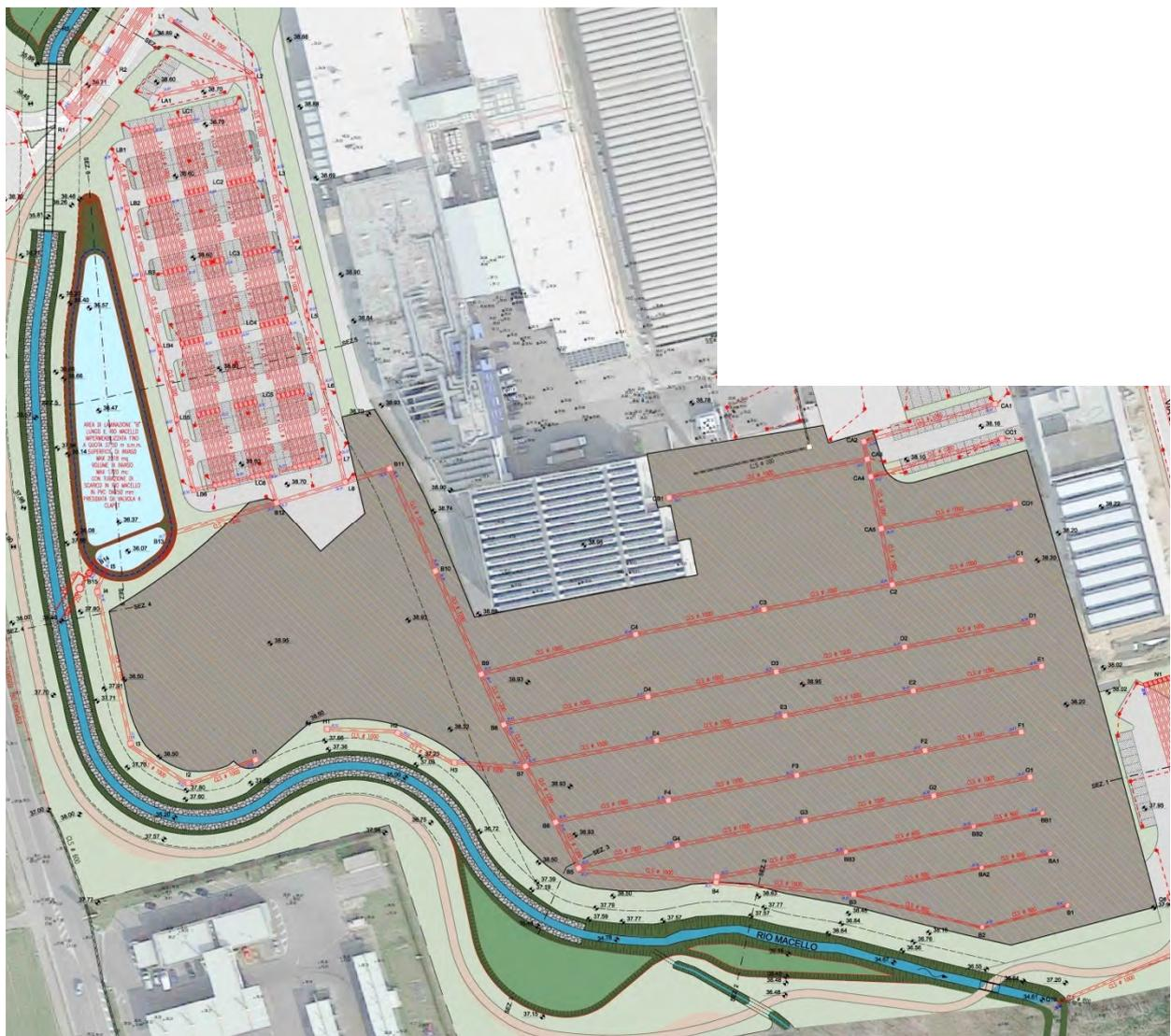
**Figura 23: Area 4 – Tubazioni di progetto e area di laminazione “B” per l’invaso dei volumi.**
