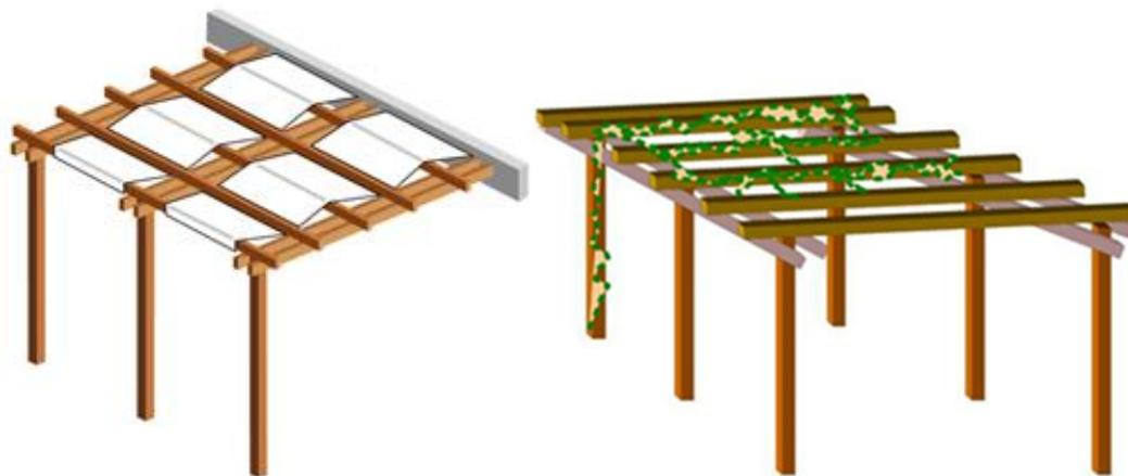
Le cosiddette pergole con struttura a "brise soleil" (e/o frangisole), realizzate in legno o in acciaio, hanno la funzione di filtrare la luce del sole e di ridurre la radiazione su terrazze, balconi o verande, consentendo di godere di un ambiente fresco e ombreggiato. E' vietata qualsiasi struttura in muratura o altro materiale ad eccezione di quelli indicati nel presente comma.
