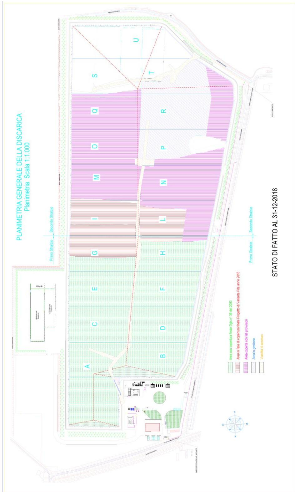
Figura 2: Planimetria relativa allo stato di avanzamento lavori con evidenza delle aree dotate di copertura definitiva (ai sensi del D.Lgs. 36/2003), dell'area con copertura provvisoria con teli in LDPE e l'area in gestione (al 31/12/2018).
