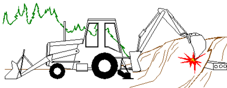
Figura 1 – Contatto con linee elettriche interrate
