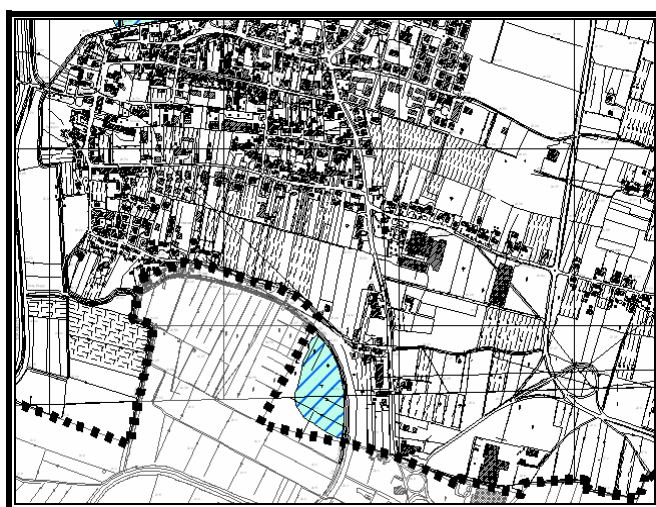
Figura 27: ATO n°4 – zona a deflusso difficoltoso
