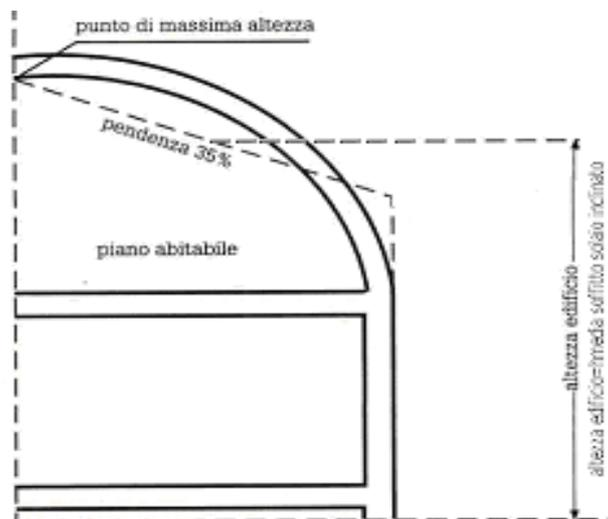
fig. 11 - Edificio con copertura ad andamento variabile con proiezione della pendenza superiore all'intradosso del solaio dell'ultimo piano abitabile
