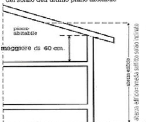
fig. 13 - Edificio con dislivello maggiore di 60 cm. e gronda inclinata
