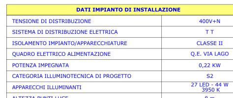
APPARECCHIO ILLUMINANTE DA ARREDO OTTICA STRADALE 27LED - 44W IP66 / CL II PALO CONICO ACCIAIO VERNICIATO Hft=8 m SISTEMA DI RIDUZIONE A BORDO APPARECCHIO BASAMENTO PER PALO DIM. 100x70x90P cm CON
