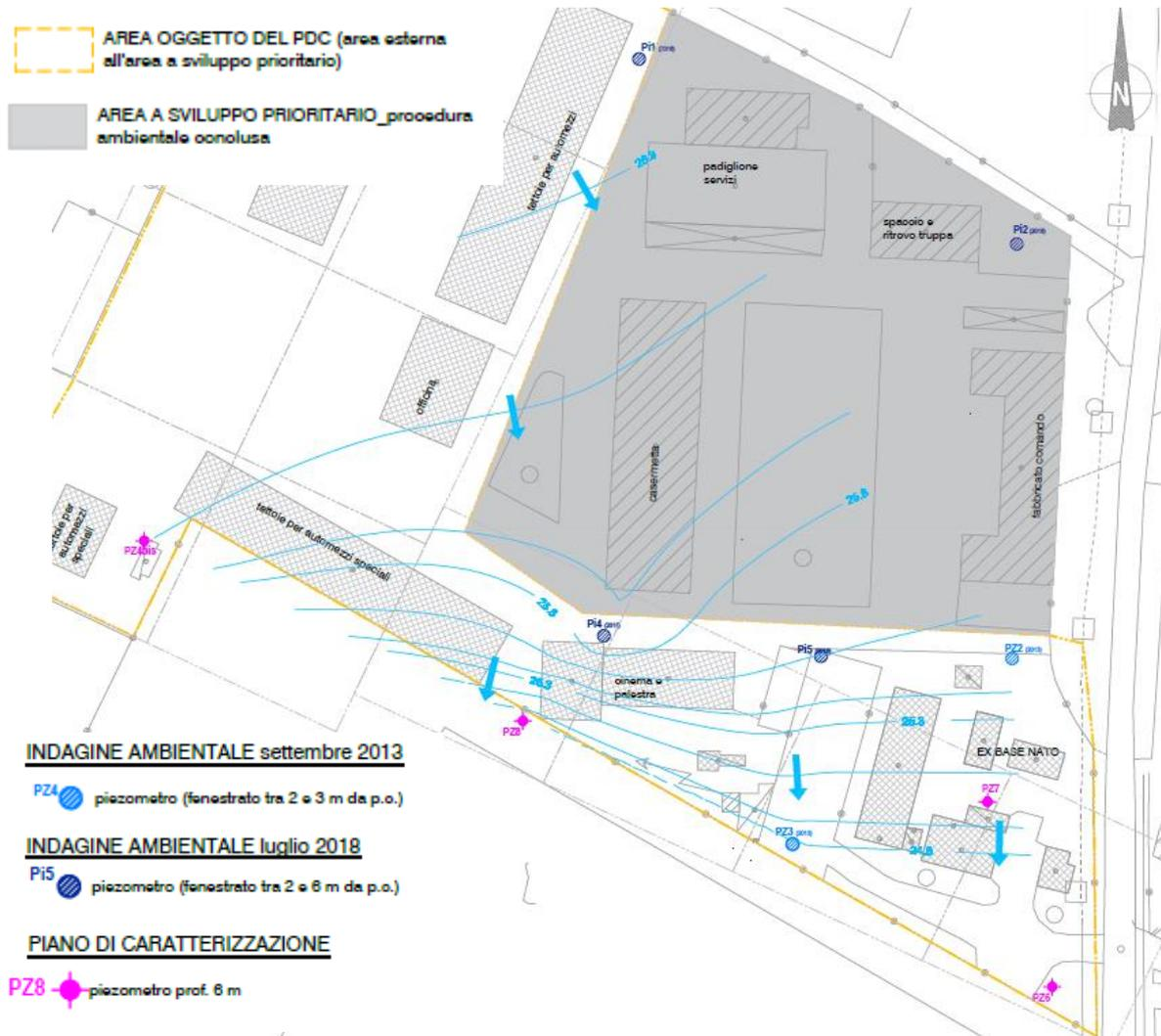
Figura 1: Ubicazione dei piezometri oggetto del monitoraggio delle acque sotterranee
