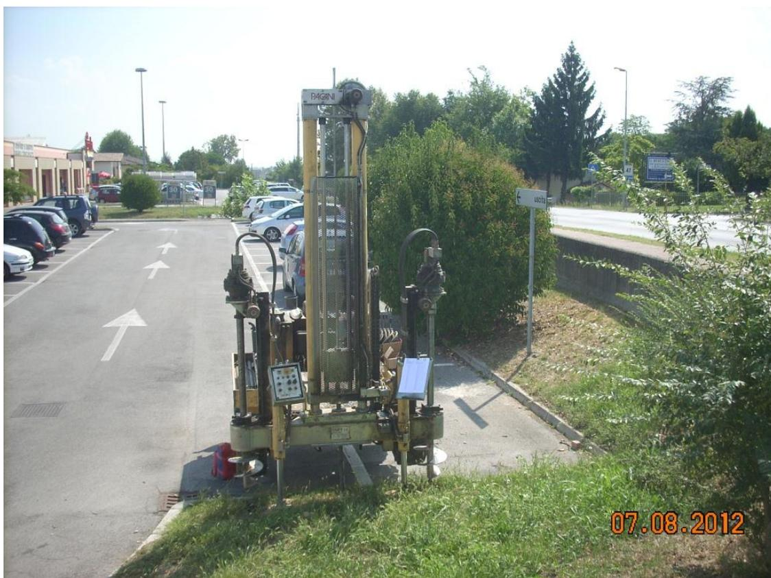
**Figura 4** – Penetrometro dinamico della ditta Pagani Geotechnical Equipment modello TG 73-200 da 20 ton posizionato sulla Prova Penetrometrica Dinamica DPSH 2
