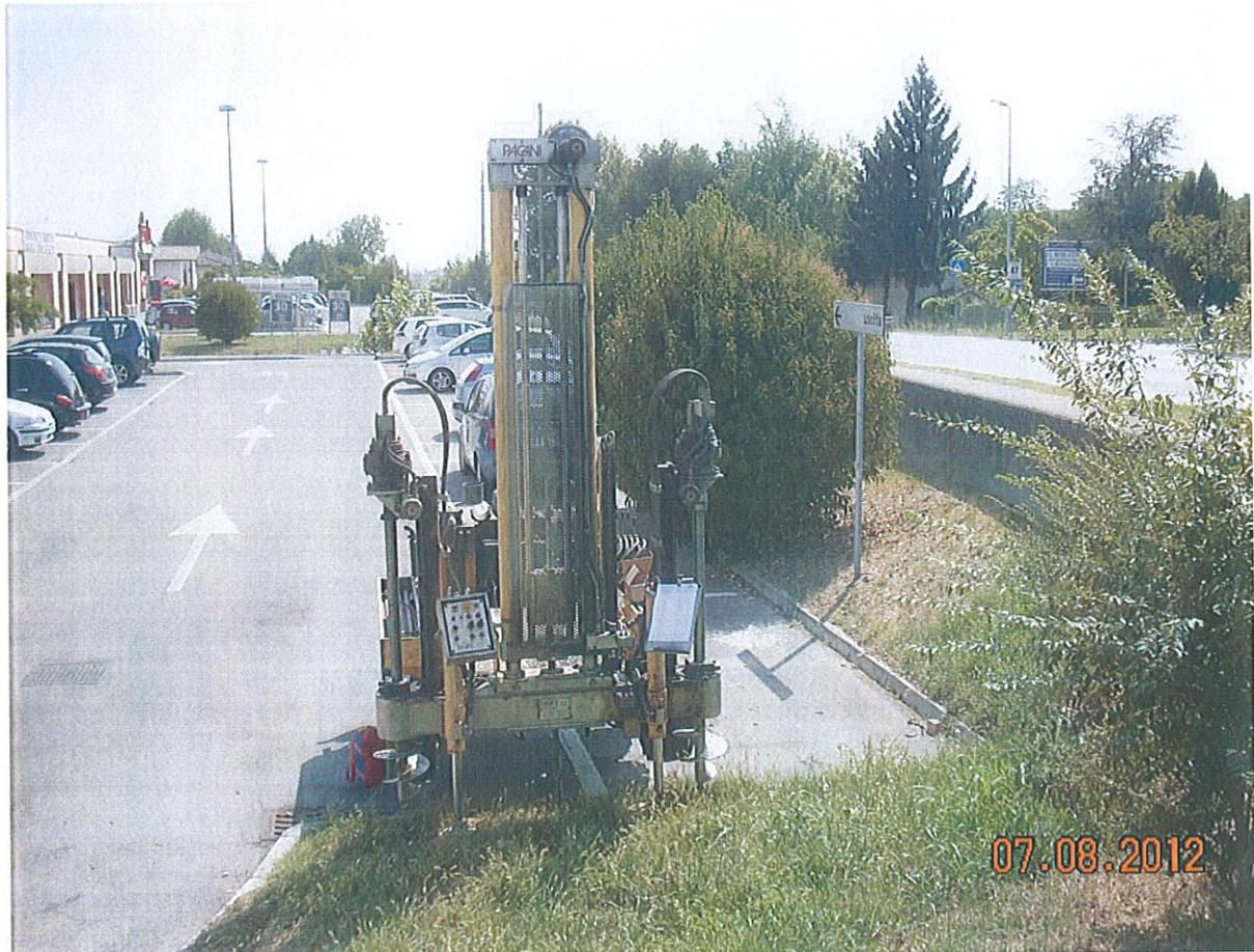
**Prova Penetrometrica Dinamica Superpesante DPSH2**
