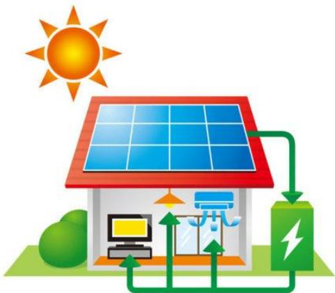
Per ovviare a questo limite e favorire l'autoconsumo – da preferire, stante l'attuale sistema tariffario – l'industria ha sviluppato appositi sistemi di accumulo ovvero batterie che, collegate all'impianto fotovoltaico, durante il giorno immagazzinano l'energia elettrica prodotta in eccesso per renderla poi disponibile quando serve.
