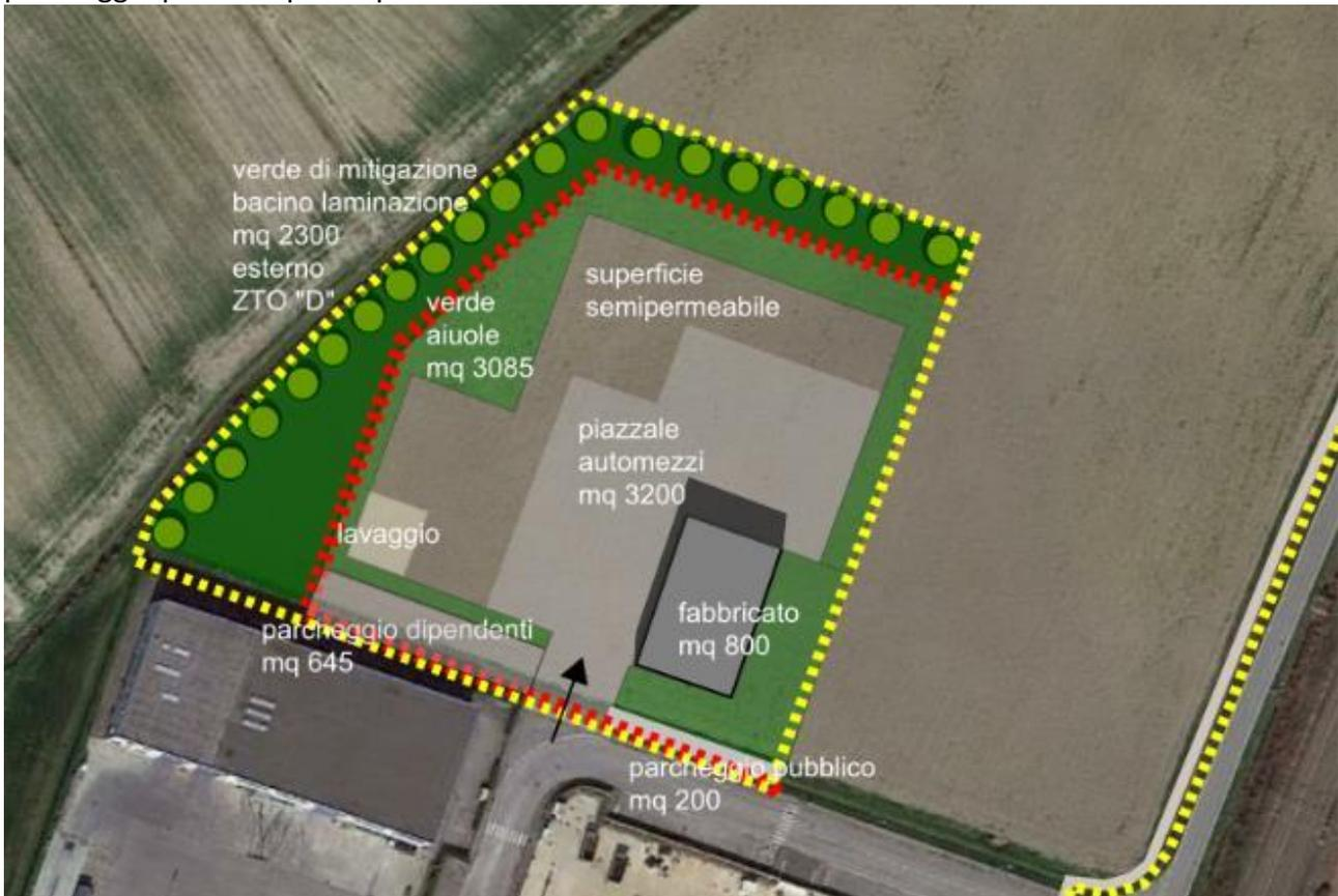
L'altezza prevista per il fabbricato è pari a ml 9,30 al vertice della veletta di finitura e ml 7,85 netti interni; nella parte uffici viene ricavato all'interno un piano oltre il piano terra; complessivamente la s.l.p. risulta quindi pari a 1.080 mq.
