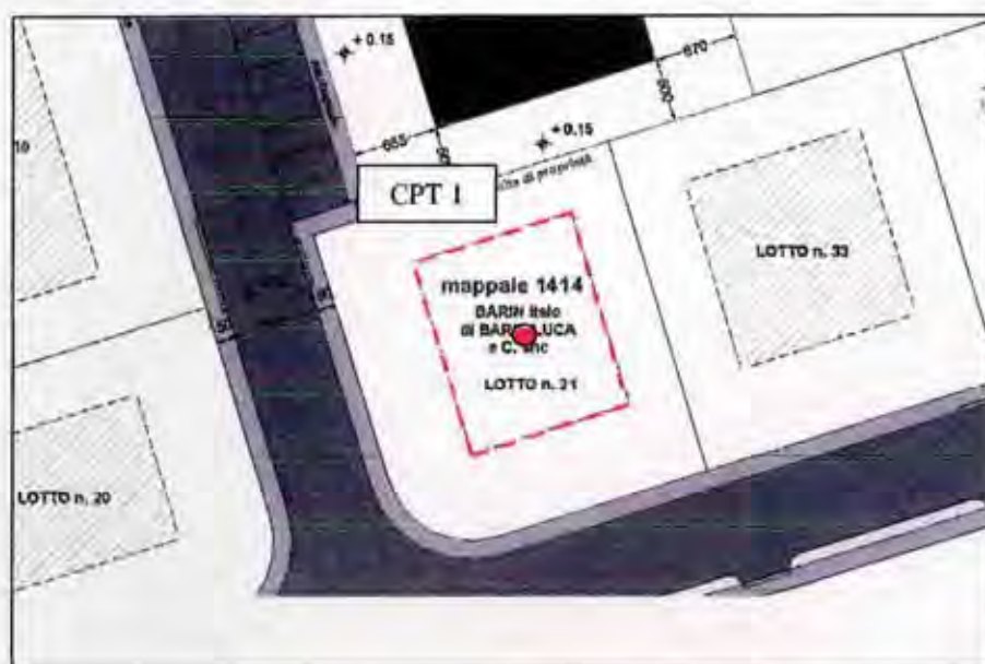
Fig. 5: planimetria di progetto e ubicazione della prova penetrometrica (scala originaria 1:100)
