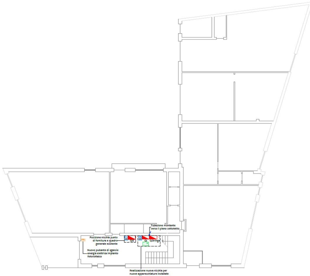
Planimetria piano terra - disposizione apparecchiature fotovoltaico
