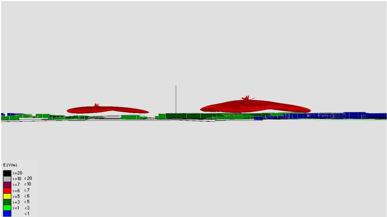
Fig. 6 Impatto Elettromagnetico – zona Via dell'Artigianato e Via Degora – Vista laterale
