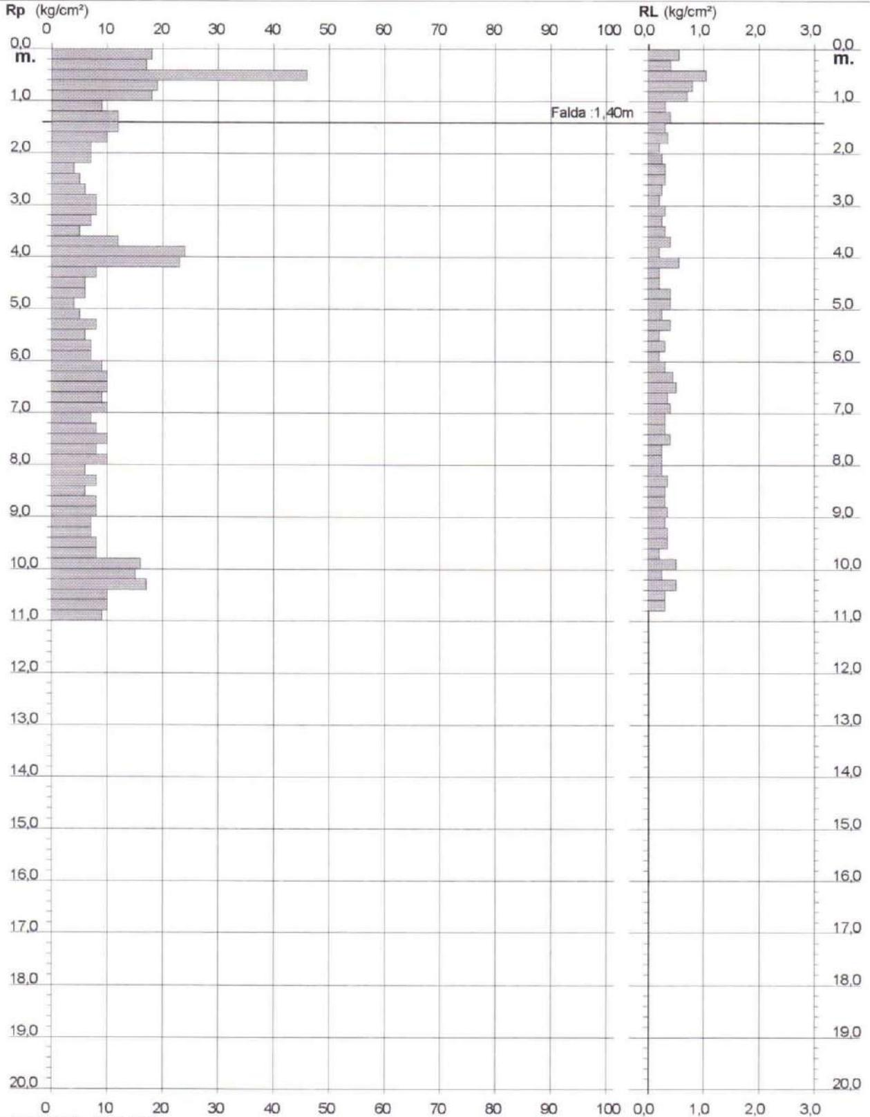
**PROVA PENETROMETRICA STATICA
