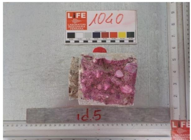
Figura 19: provino sottoposto a test colorimetrico - campione ID 05
