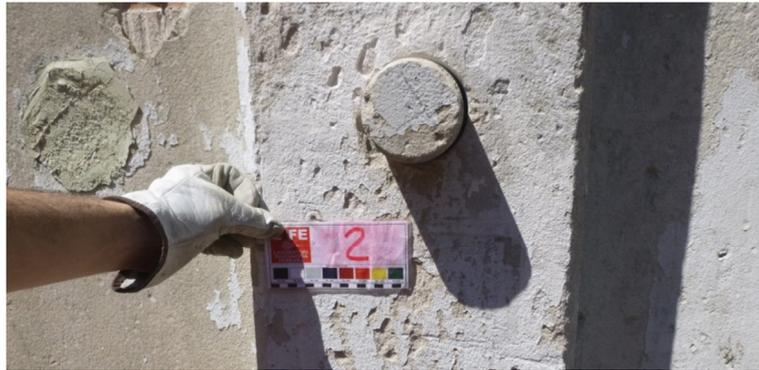
Figura 7: area in cui è stato prelevato il campione mediante carotaggio – indagine ID 02
