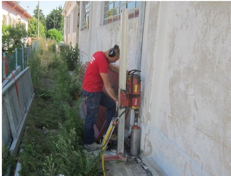
Figura 22: esecuzione del carotaggio in fondazione - indagine ID 9
