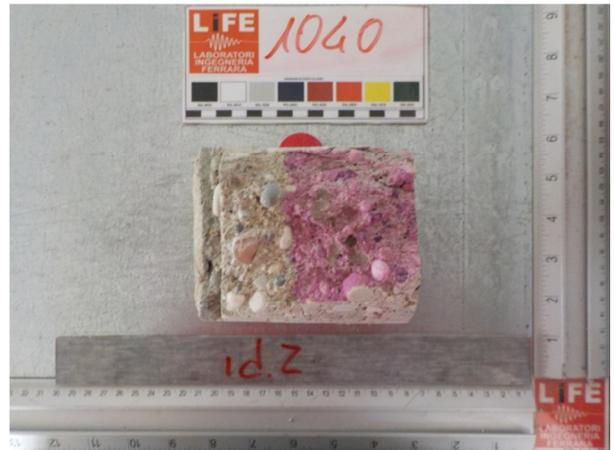
Figura 17: provino sottoposto a test colorimetrico - campione ID 02
